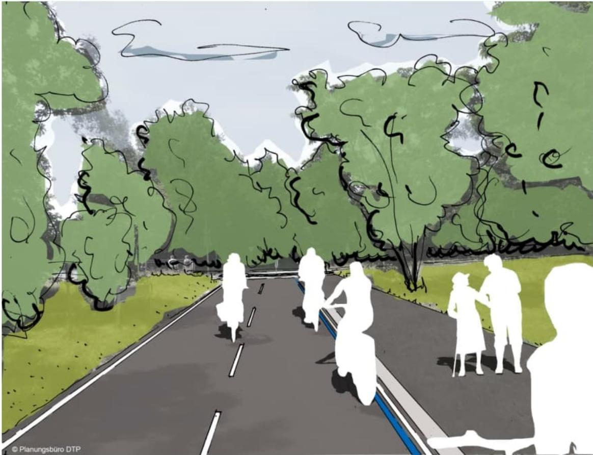
Entlang des Seewiesenwegs in Nürnberg wird ein getrennter Geh- und Radweg im Radschnellweg-Standard umgesetzt. Die Fahrrichtungen für den Radverkehr sind durch eine Mittelleitlinie voneinander getrennt.
