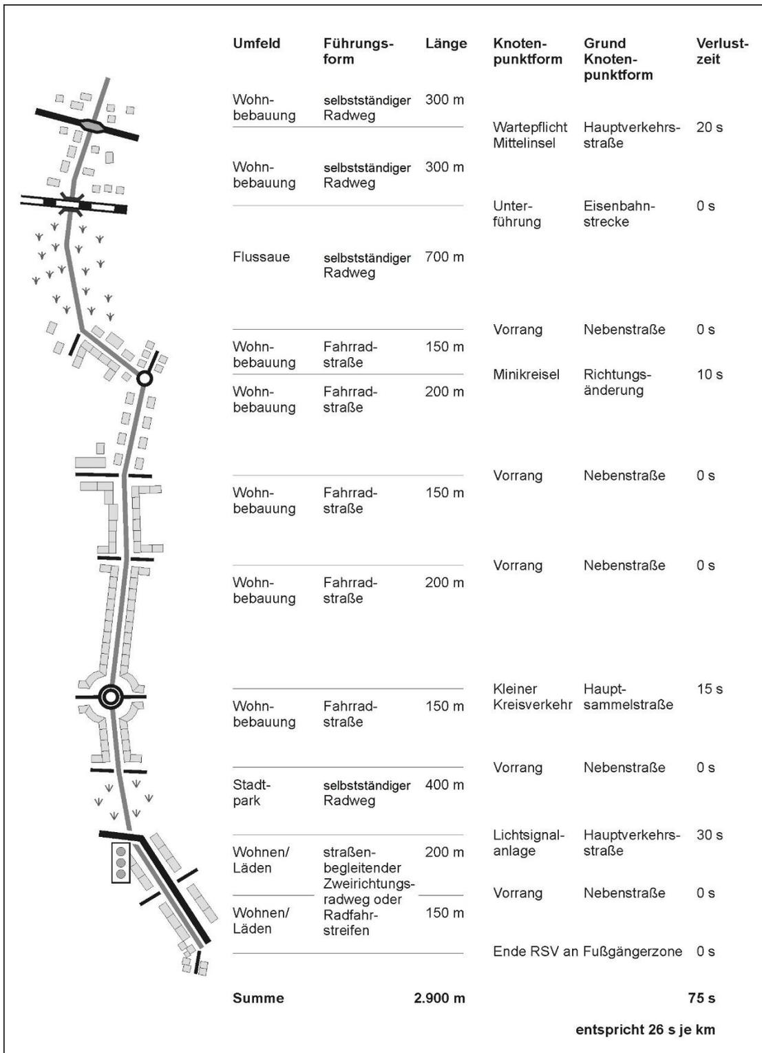
Abbildung 15: Verlustzeiten an verschiedenen Knotenpunktformen einer Radschnellverbindung<sup>16</sup>
