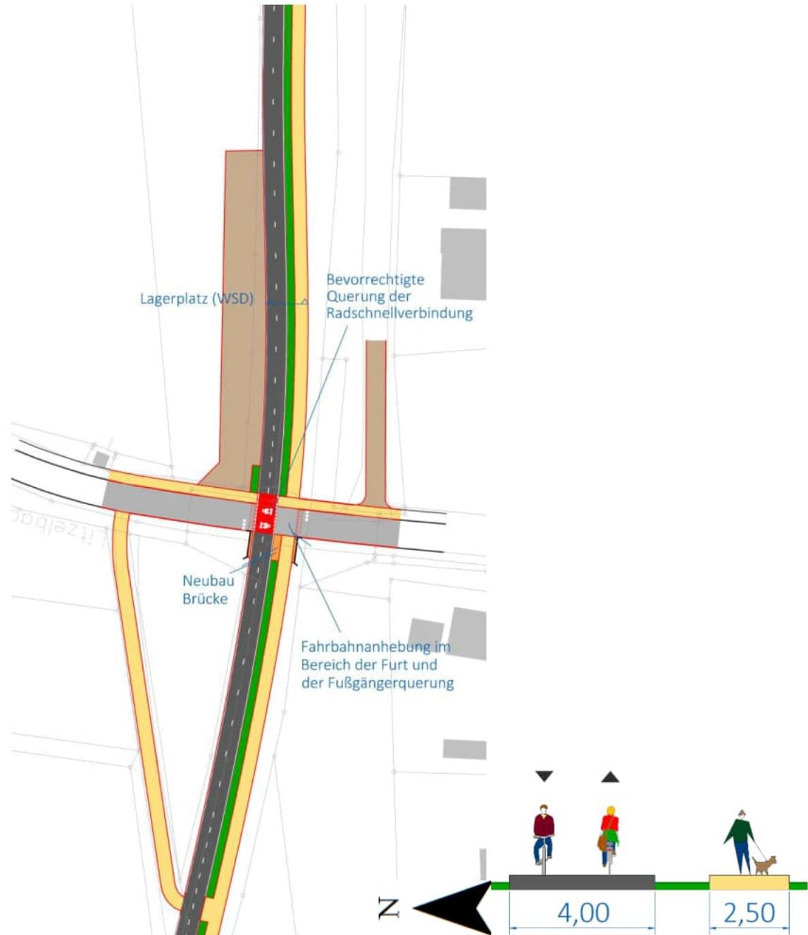
Der Radschnellweg wird bevorrechtigt über die Hauptendorfer Straße geführt. Die Fahrbahn in diesem Bereich wird angehoben. Die Brücke über den Litzenbach muss im diesem Zuge erneuert und verbreitert werden.
