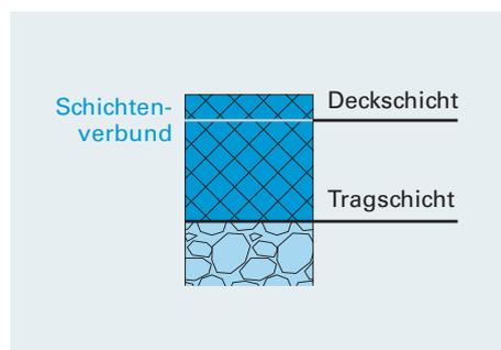
**Abb. 8:** Schichtenverbund zwischen Deck- und Tragschicht
